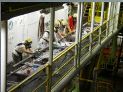
Ankunft eines Kern auf dem 'Catwalk'. Sulfidreiche Sedimentkerne werden unter Schutzmasken bearbeitet.
