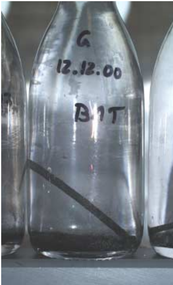
Biokorrosion durch sulfatreduzierende Bakterien
